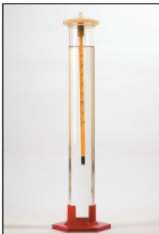
↑ Introduzir o termômetro na proveta, tendo o cuidado de manter a coluna de líquido termométrico totalmente imersa. Uma vez estabilizada a temperatura, efetuar a leitura e anotar.
