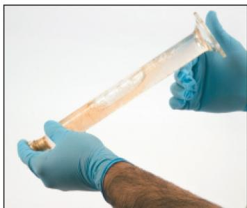
← Tampar e inverter a proveta por pelo menos dez vezes, evitando a agitação enérgica, para completar a extração do etanol para a fase aquosa (etanol na água).
