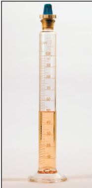
← Colocar 50 ml da amostra na proveta de 100 ml, previamente limpa, desengordurada e seca.
